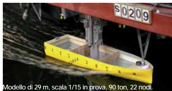
Modello di 29 m, scala 1/15 in prova, 90 ton, 22 nodi.
